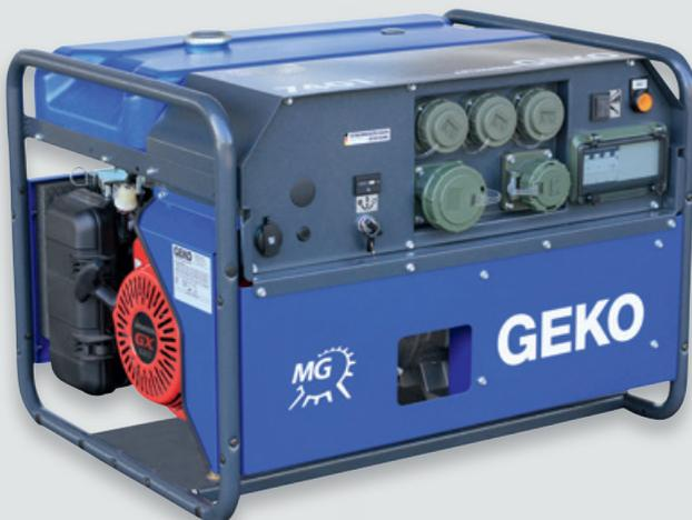
Silenausführung mit großem Luftfilter und großem Schalldämpfer
