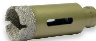
**Diamantbohrkrone M14, für Winkelschleifer Ø 115mm und 125mm** · zum Bohren von sauberen, kantenschärpen Löchern in Feinsteinzeug, Steinplatten, Granitplatten, Fliesen, Keramik und Marmor · max. Bohrtiefe 70 mm · **Segmenthöhe 15 mm**
